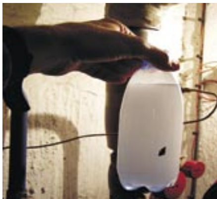
Vykurovacia voda nasýtená plynom je ihneď po vypustení biela – sfarbená mikrobublínkami. Po niekoľkých minútach bublinky vyprchajú a voda sa vyčistí. Je to dôkaz obsahu plynov vo vykurovacej vode.
