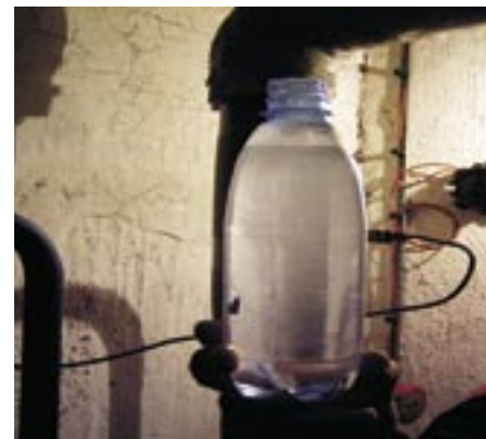
Vykurovacia voda nasýtená plynom je ihneď po vypustení biela – sfarbená mikrobublínkami. Po niekoľkých minútach bublinky vyprchajú a voda sa vyčistí. Je to dôkaz obsahu plynov vo vykurovacej vode.
